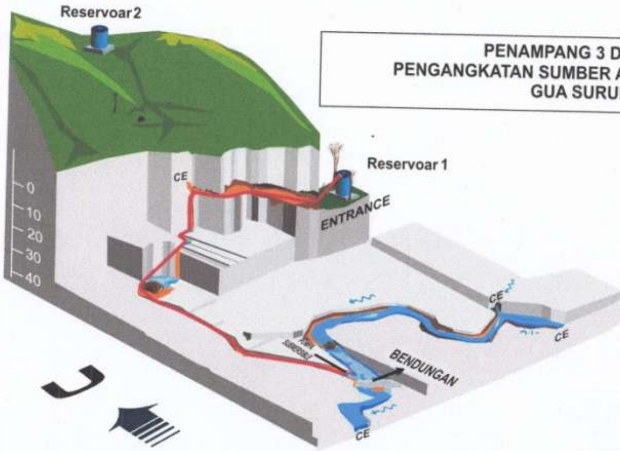
Gambar 8. Penampang Tiga dimensi Pengangkatan Sumber Air
